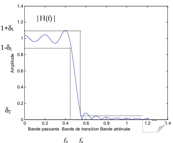
dont l'amplitude est exprimée par les paramètres d'ondulation en bande passante  $\delta_1$  et bande atténuee  $\delta_2$  [9].
