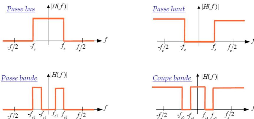
Les filtres représentés ci-dessus sont idéaux. Dans un cas réel il n'est pas possible d'obtenir une fréquence de coupure aussi raide. Le passage entre zones passantes et zones atténuées se fait par des zones dites "de transition"  $f_p-f_a$  dont la largeur va exprimer la sélectivité du filtre. Par ailleurs, les bandes passantes et atténuées ne sont également pas idéales, elles contiennent des ondulations
