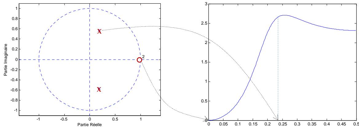
Remarque : Puisque les coefficients du filtre sont réels, les pôles et zéros sont réels (sur l'axe des réels) ou paires de complexes conjugués.
