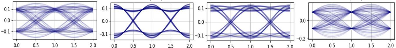
4. On souhaite réaliser une chaîne de transmission en bande de base avec un filtre de mise en forme  $h_e(t)$  et un filtre de réception  $h_r(t)$  en racine de cosinus surélevé de paramètre  $\alpha$ . Le canal utilisé a une bande passante limitée  $BP = 1$  MHz. On souhaite transmettre avec un débit binaire de  $D_b = 3.5$  Mbits/seconde.
