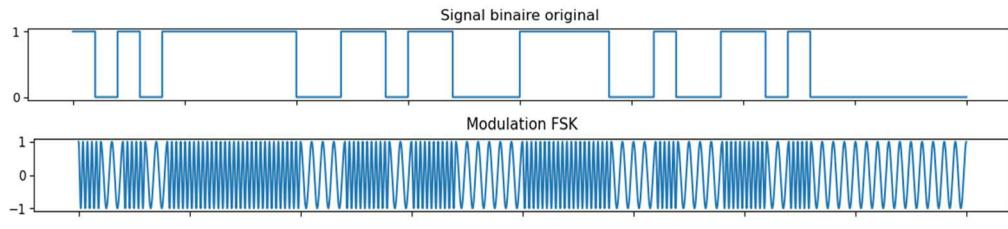
CP-FSK : FSK à phase continue  $\delta_f \geq \frac{1}{2T_B}$
