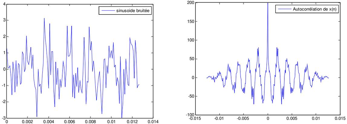
La corrélation est largement utilisée dans les systèmes radar. Ainsi, pour détecter un avion, on envoie une impulsion, puis on reçoit une version retardée, atténuée et bruitée de cette impulsion. L'intercorrélation du signal reçu et émis présentera un pic à l'instant correspondant au retard.
