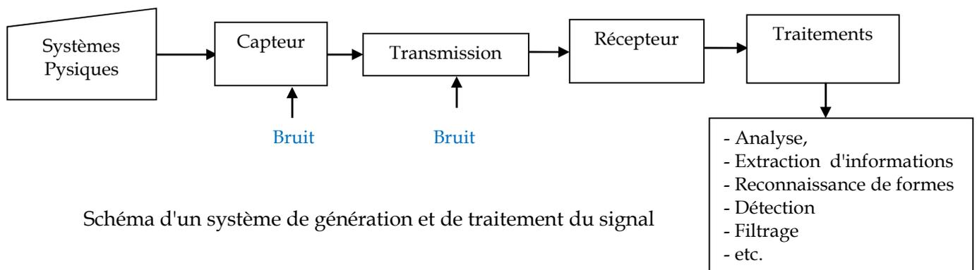
Schéma d'un système de génération et de traitement du signal
