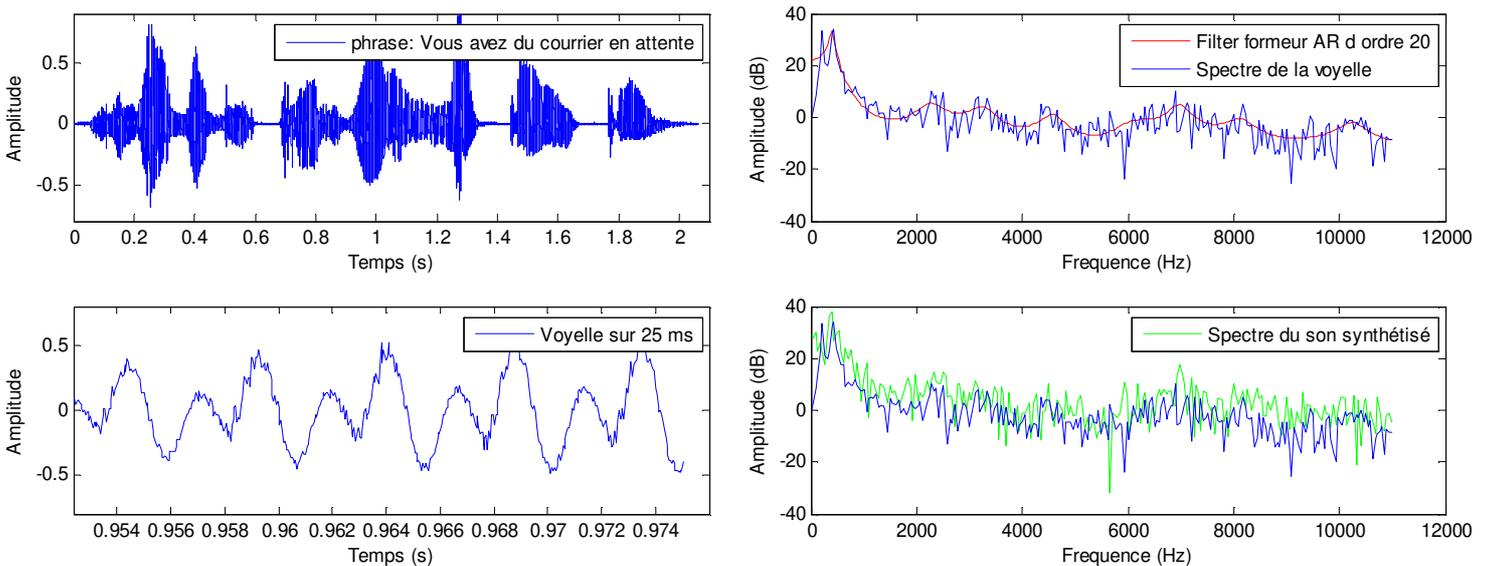
En comparant l'allure du filtre formeur  $H(f)$  à celle de  $S_y(f)$ , on note que l'on retrouve l'allure générale du spectre de la voyelle, notamment les fréquences dont la puissance est maximale. Sachant que le spectre de la voyelle comporte 500 valeurs et que le filtre  $H(f)$  équivalent est obtenu à partir de 20 coefficients, il vaut mieux transmettre 21 coefficients (20  $a_i$  + variance du bruit) que 500 valeurs.
