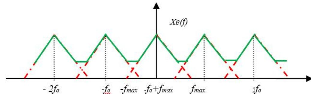
$\Rightarrow$  une fréquence d'échantillonnage égale à la fréquence de Nyquist ( $f_e/2 > f_{max}$ )
