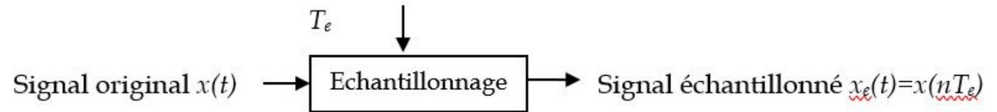
Echantillonner un signal : Prélever régulièrement des échantillons du signal analogique pour le rendre discret (temps) et permettre, ainsi, sa numérisation.
