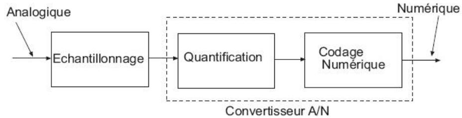
Echantillonner un signal : Prélever régulièrement des échantillons du signal analogique pour le rendre discret (temps) et permettre, ainsi, sa numérisation.
