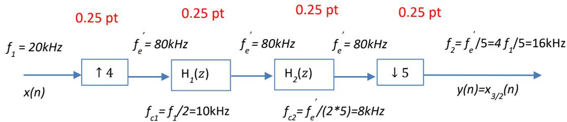
2. Donner la fréquence d'échantillonnage à la sortie de chaque bloc.
