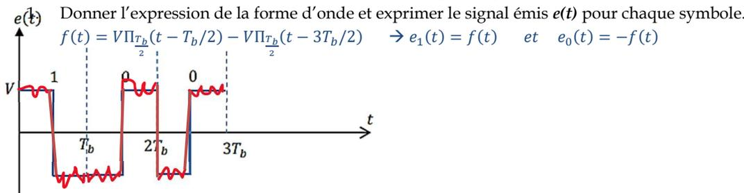
On suppose que le signal reçu est affecté d'un bruit additif blanc Gaussien de puissance 0.09V que l'on veut filtrer par un filtre optimal.
