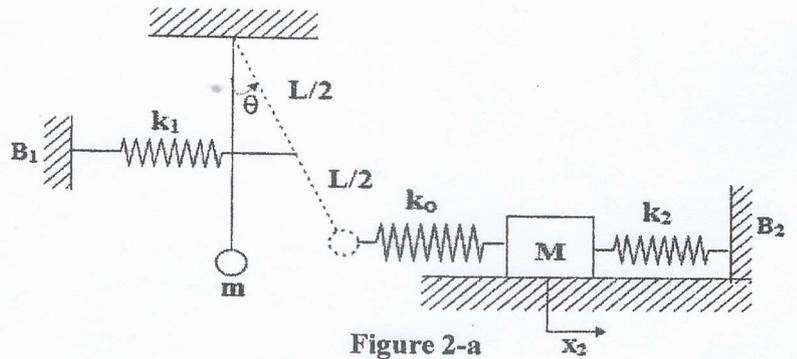
1- En posant :  $m = M$ ,  $k_1 = 4k$ ,  $k_2 = 2k$ ,  $\frac{mg}{L} = k$ , et  $x_1 = L\theta$ ; Montrer que les équations du mouvement
