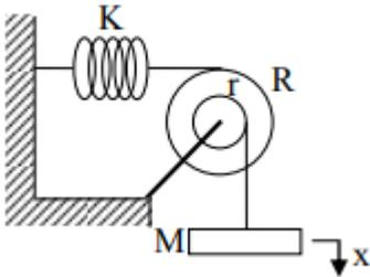
On considère le système mécanique de la figure ci-contre constitué d'un ressort de raideur  $K$  accroché à un fil inextensible qui s'enroule autour d'une poulie de rayon extérieur  $R$  et de masse négligeable. Une masse  $M$  est reliée à la partie centrale de
