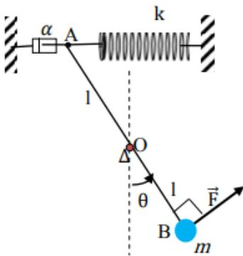
Une tige  $AB$ , de longueur  $l$ , rigide et de masse négligeable, peut tourner, dans le plan vertical autour d'un axe fixe passant par son milieu  $O$ . L'extrémité  $A$  de la tige est reliée à un bâti fixe par l'intermédiaire d'un ressort de raideur  $k$ . A l'extrémité  $B$  de la tige est fixée une masse ponctuelle. Les frottements sont modélisés par un amortisseur de coefficient de frottement visqueux  $\alpha$ . La position de la masse est
