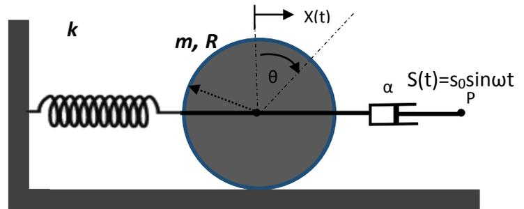
1- Etablir l'équation différentielle du mouvement du système et préciser les expressions du facteur d'amortissement  $\delta$  et de la pulsation propre  $\omega_0$ .
