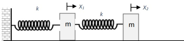
Deux masses identiques sont reliées comme sur la figure ci-dessus par des ressorts identiques de raideur  $k$ . L'ensemble peut se déplacer horizontalement sans frottement. Les déplacements par rapport aux positions d'équilibre des deux masses sont notés  $x_1(t)$  et  $x_2(t)$ .
