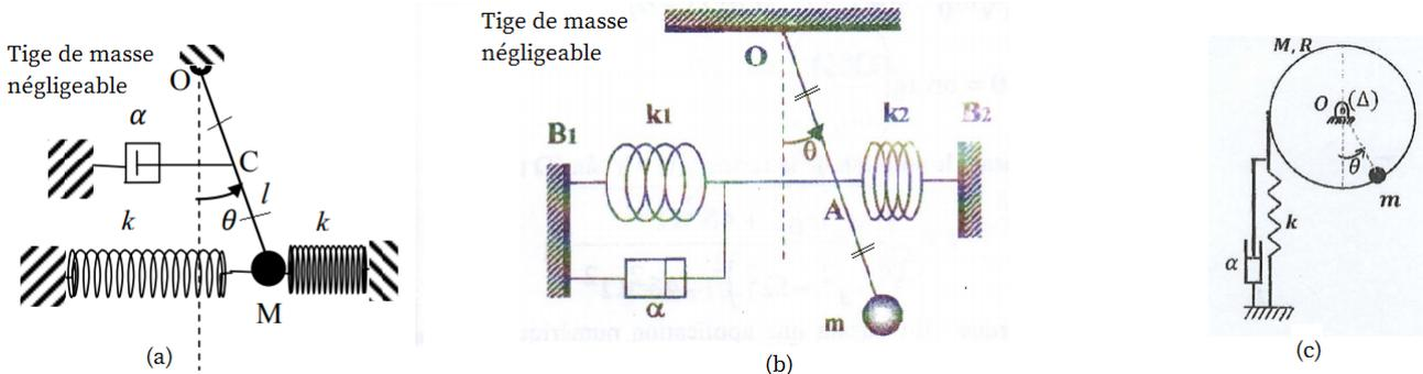
Un oscillateur 1ddl libre amorti possède les quantités physiques suivantes :  $Ec = \frac{1}{2}a\dot{q}^2$  ,  $Ep = \frac{1}{2}bq^2$  ,  $D = \frac{1}{2}c\dot{q}^2$
